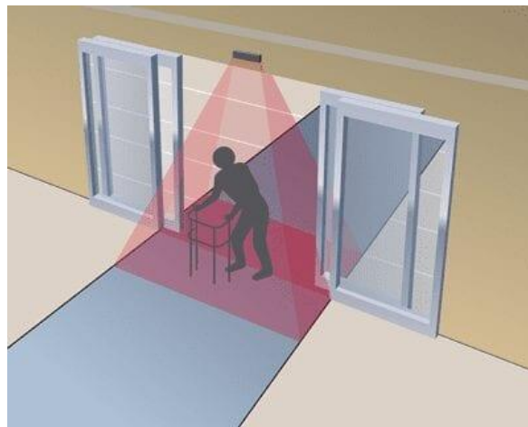
รูปที่ 1 ประตูบานเลื่อนเซ็นเซอร์ (บริษัท ดอลลี โซลูชั่น จำกัด, 2564)
